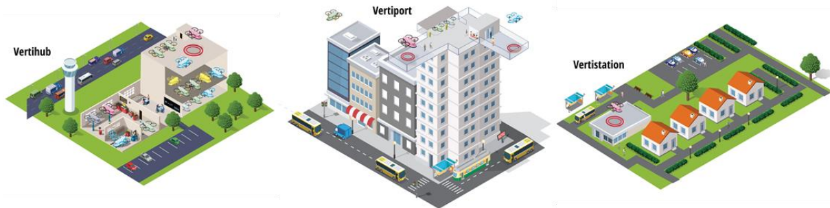
Abbildung 3: Illustration möglicher Anwendungs- und Größenkategorien von Vertiports. Entnommen aus: [17]
