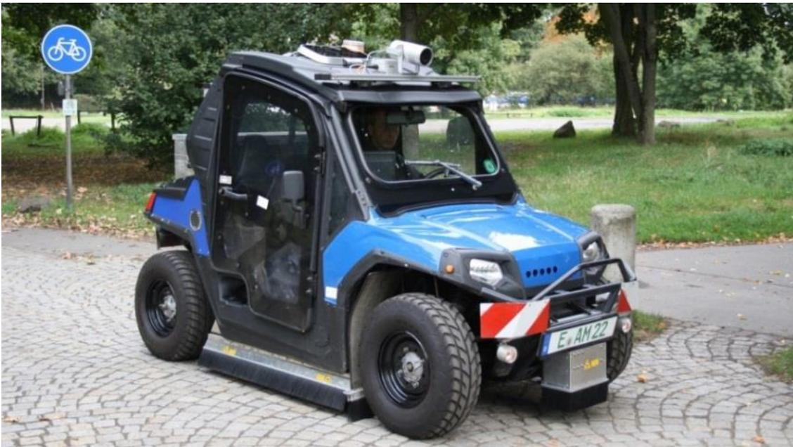
**Bild 2** Kleinmessfahrzeug (TÜV Rheinland Schniering GmbH)
