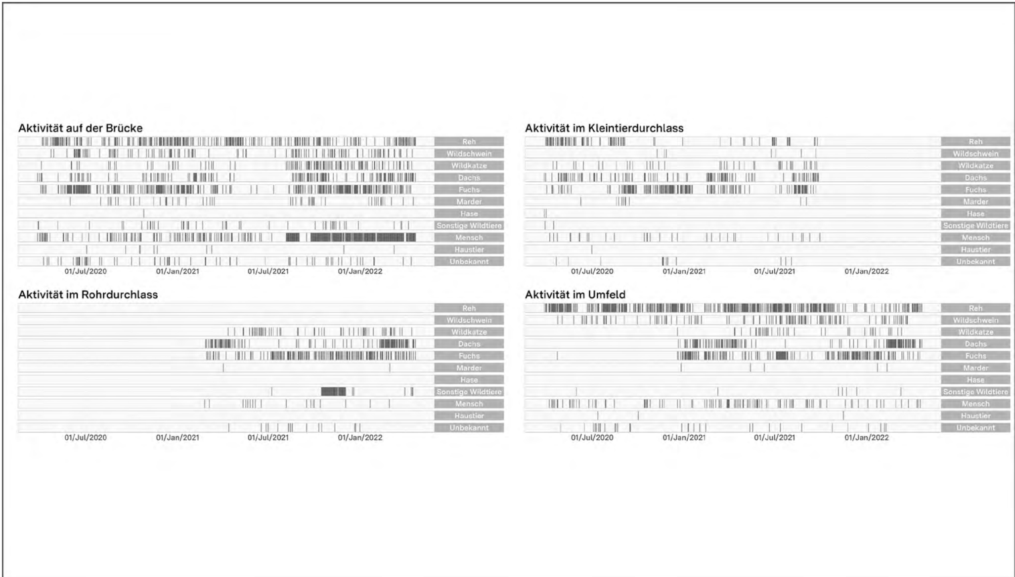
Abbildung 39: Nachweise von Wildtieren als auch menschlichen Aktivitäten aus dem Fotofallenmonitoring auf der Grünbrücke Sasbach, in den Durchlässen, sowie für das Umfeld der Bauwerke für den Zeitraum März 2020 bis April 2022. Der Rohrdurchlass wurde erst ab dem 24.02.2021 und der Kleintierdurchlass nur bis zu dem 29.09.2021 überwacht. Jeder Strich symbolisiert das Vorkommen der Art an dem Tag, unabhängig der Anzahl der Tiere. Menschen und Rehe querten den Kleintierdurchlass und den Rohrdurchlass nicht, sondern liefen nur daran vorbei.
