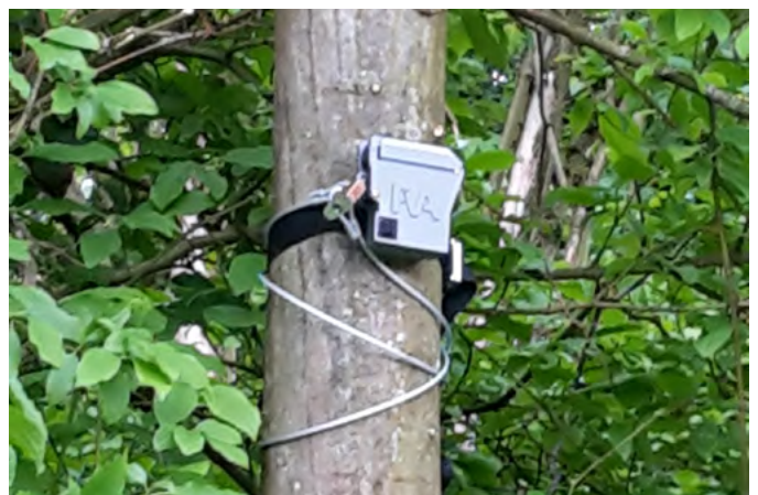
Abbildung 21: Autonome Audiorekorder der Marke AudioMoth zum Nachweis von Fledermäusen.
