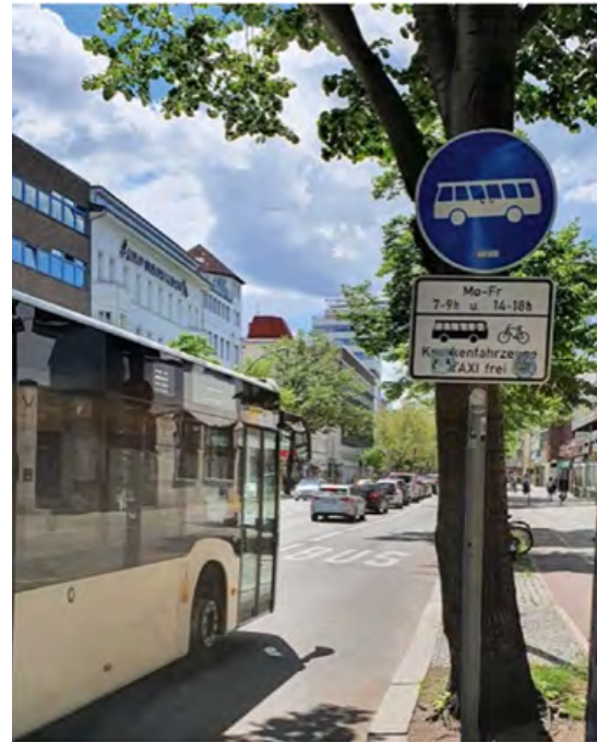
Abb. 4: Temporäre Bussonderfahrstreifen mit Freigabe für ausgewählte andere Verkehrsmittel
