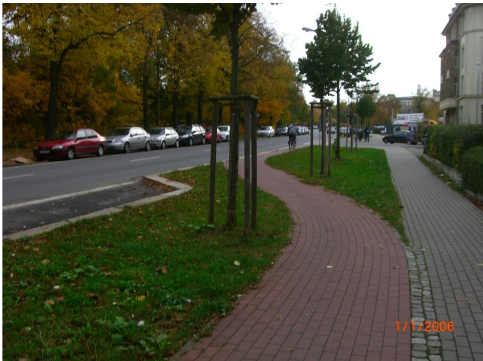
Abb. 6 Vorgezogener Radweg vor einer Einmündung
