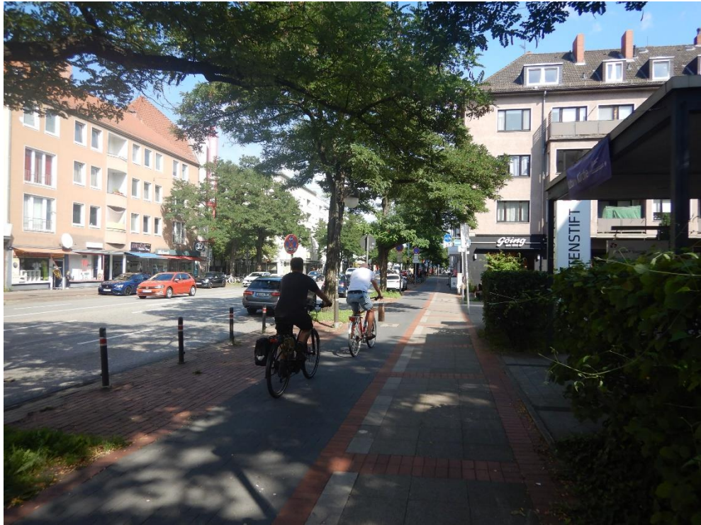
Abb. 5 Vorgezogener Seitenraum im Sichtfeld zwischen Radweg und Fahrbahn
