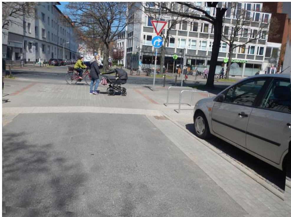
Abb. 3 Radwegüberfahrt an einer Einmündung
