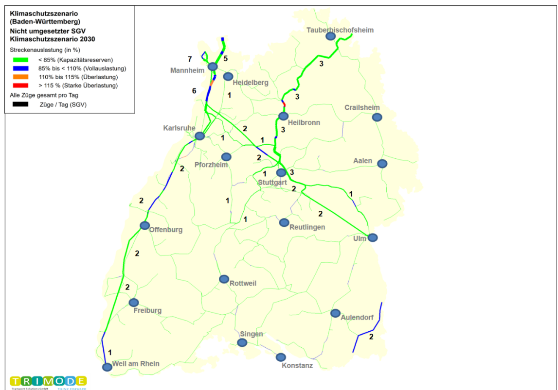
Abbildung 7-6: Aus Überlastungsgründen nicht fahrbare Züge im Klimaschutzszenario in Baden-Württemberg in 2030 (SGV-Züge pro Tag)
