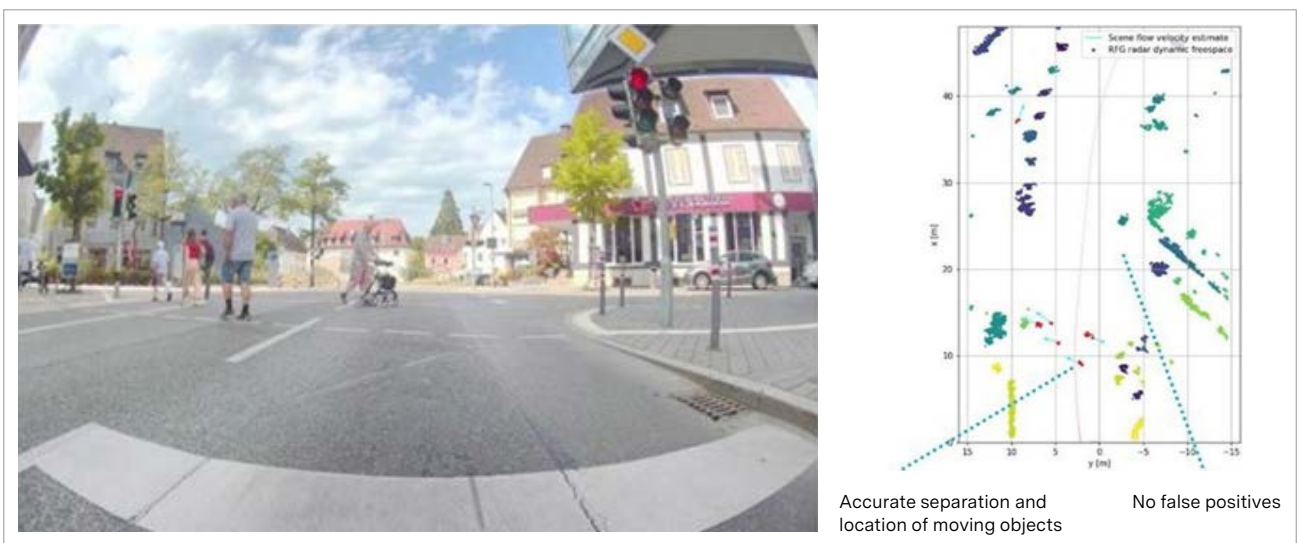
Abbildung 7: Exemplarische Darstellung der Objekterkennung mittels Radar
