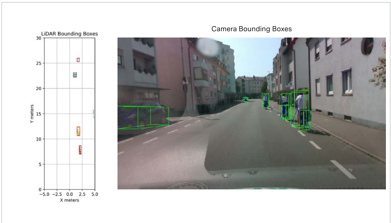
Abbildung 45: eWolf Hinderniserkennung beim Szenario „Radfahrer fährt längere Zeit vor dem Fahrzeug“
