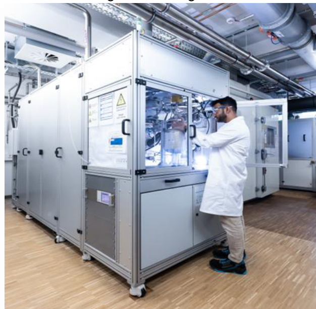
Abbildung 3: Die DAC-Teststände am Fraunhofer ISE: mixSorb (links) und DACTrap (rechts). Der DACTrap Teststand wurde innerhalb dieses Projekts in Betrieb genommen.
