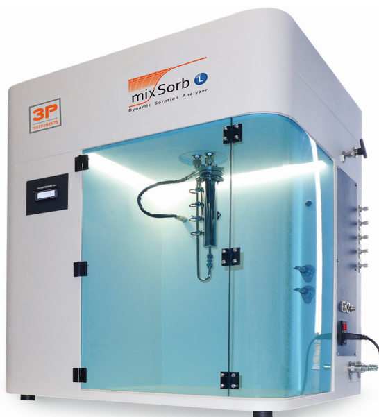
Abbildung 3: Die DAC-Teststände am Fraunhofer ISE: mixSorb (links) und DACTrap (rechts). Der DACTrap Teststand wurde innerhalb dieses Projekts in Betrieb genommen.
