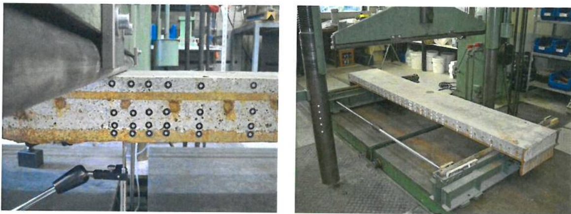
Bild 6 Anordnung der Messmarken zur Erfassung der Verformungen mit dem bildoptischen PONTOS-System in Plattenmitte (links) und in der Übersicht (rechts)
