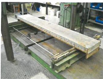
Bild 5 Versuchsaufbau zur Bestimmung des Last-Verformungsverhaltens (Maße in [m]) und die Lage der induktiven Wegaufnehmer zur Erfassung der Durchbiegung in Plattenmitte
