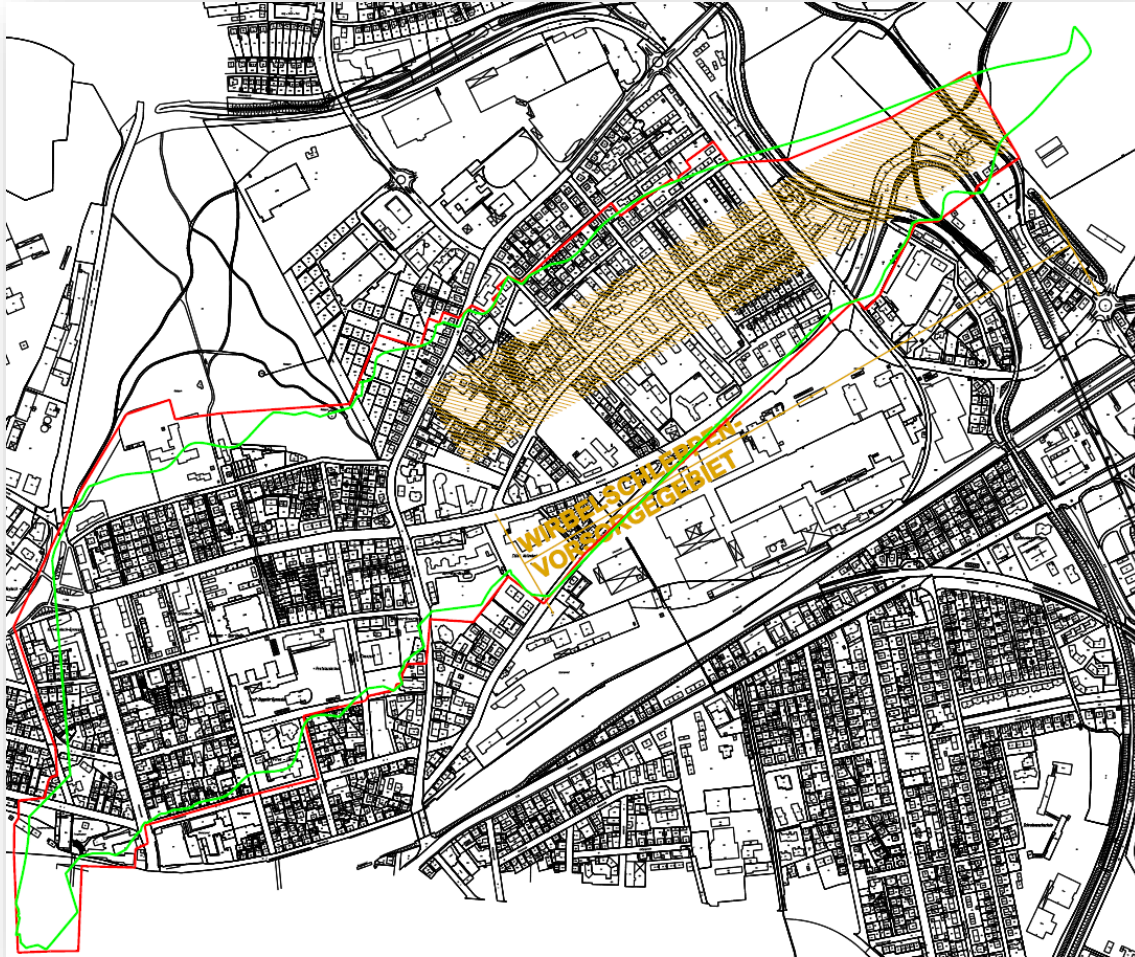
Abbildung 1: Neuberechnete 1 \times 10^{-2} Konturen ohne Boeing B757 (grün) im Vergleich mit den Wirbelschleppen-Vorsorgegebieten gemäß GfL Gutachten (rot) und den bestehenden Vorsorgegebieten (orange) für den Anflug auf Schwelle 06
